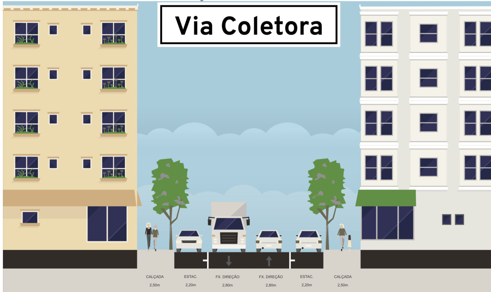
Figura 5 - Perfil viário - Via coletora
